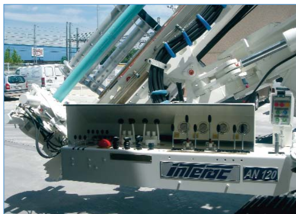
El brazo de mando hidráulico es abatible. Existe la opción de equipar control remoto por cable o radio.
