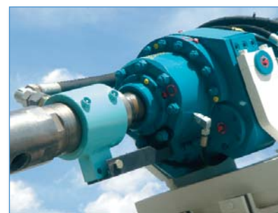
La disposición longitudinal del motor permite un fácil mantenimiento del equipo.
