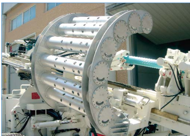
El cargador de doble tubería en arco circular adaptable es para siete tubos dobles de hasta 133 mm de tubo exterior y 88,9 mm de tubo interior.
