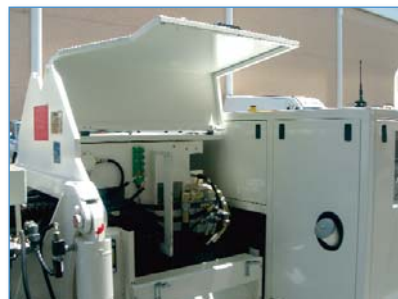
La disposición longitudinal del motor permite un fácil mantenimiento del equipo.
